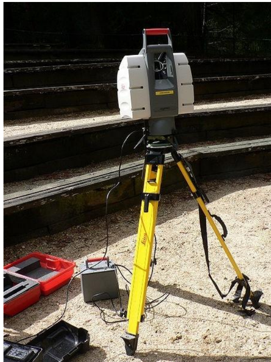
Figure 2: Laser “range finder” utilizado em medição de imperfeições em estruturas de grande escala. Fonte[6].
